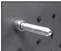
Posizionare il chiodo nel foro delle lamiere da assemblare. Inserire la boccola lungo l'asta del chiodo e farla aderire ai particolari da assemblare.
