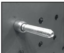
Vložte střížný kolík do vyvrtaného otvoru a nasadte límec(kroužek) na střížný kolík co nejtěsněji k materiálu, který má být spojen
