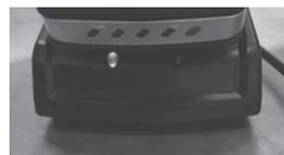
Luce verde sul carica batterie: la batteria è completamente carica.
