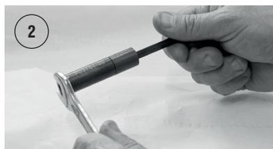
2 Oddělte sestavu 2 až 8 od kusu 1, potom odšroubujte část 2 od části 7, přičemž držte konec kusu 2 SW klíčem (14 mm) a pomocí dodávaného šestihránného klíče (6 mm)
