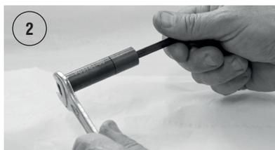
Séparer l'assemblage 3 à 8 de la pièce 2. Puis dévisser la pièce 3 de la pièce 8 en maintenant l'extrémité de la pièce 3 avec une clef SW (14mm) et à l'aide de la clef hexagonale (6mm) fournie.
