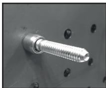
Umieść nit w otworze elementu przeznaczonego do montażu, a następnie umieść pierścień wzdłuż pręta, w kontakcie z częścią, która ma zostać zmontowana
