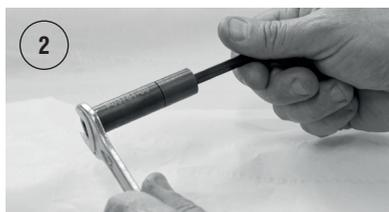
Séparer l'assemblage 2 à 8 de la pièce 1. Puis dévisser la pièce 2 de la pièce 7 en maintenant l'extrémité de la pièce 2 avec une clef SW (14mm) et à l'aide de la clef hexagonale (6mm) fournie.
