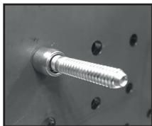
Placer le goujon dans le trou de perçage de la pièce à assembler, puis enfiler la bague le long de la tige, en contact de la pièce à assembler
