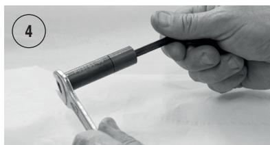
Puis remonter l'ensemble. Visser la pièce 2 sur l'assemblage 3 à 7 : Serrer l'ensemble à l'aide de la clef hexagonale (6mm) fournie et d'une clef de 14mm.
