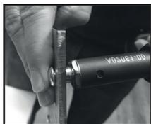
Positionner l'outil sur la tige jusqu'au contact de la bague
