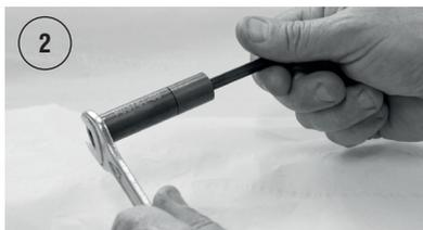
Oddělte sestavu 2 až 8 od kusu 1, potom odšroubujte část 2 od části 7, přičemž držte konec kusu 2 SW klíčem (14 mm) a pomocí dodávaného šestihřanného klíče (6 mm).
