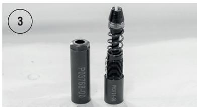
Positionner l'assemblage des pièces 4 à 8 verticalement.
