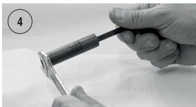
Puis remonter l'ensemble. Visser la pièce 3 sur l'assemblage 4 à 8. Serrer l'ensemble à l'aide de la clef hexagonale (6mm) fournie et d'une clef de 14mm.
