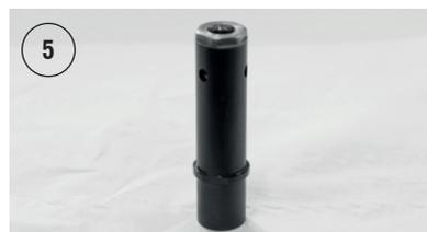
Positionner le joint 8. Insérer l'assemblage 2 à 8 dans la pièce 1. Remonter le nez de pose selon la section «**Installer le kit de pose sur l'outil**» p 18.
