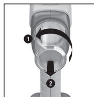
Upewnij się, że w pojemniku na trzpień jest dostatecznie dużo miejsca na wpadające trzpień. Pojemnik na trzpień można łatwo opróżnić :
